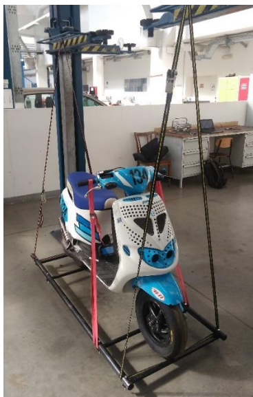
Obr. 31 Vozidlo + kyvadlo v rovnovážné poloze před změřením momentu setrvačnosti k ose x
