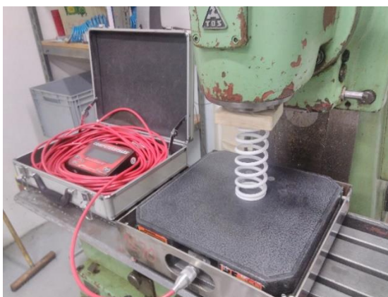
Obr. 38 Metodika měření tuhosti pružiny
