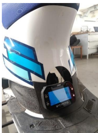
Obr. 28 Datalogger s tříosým akcelerometrem a gyroskopem umístěný co nejbližší těžišti motocyklu
