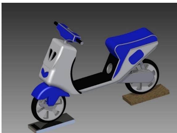
Obr. 14 Metodika měření polohy těžiště v podélném směru
