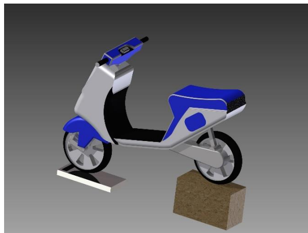
Obr. 17 Metodika měření výškové polohy těžiště motocyklu
