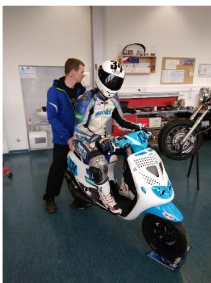
Obr. 20 Měření podélné polohy těžiště motocyklu s jezdce v pozici "brždění" (ilustrativní foto)
