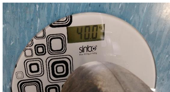
Obr. 19 Naměřená hmotnost pod zadním kolem
