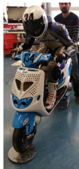
Obr. 21 Měření výškové polohy těžiště motocyklu s jezdce v pozici "rovinka"
