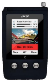
Obr. 54 On-board kamera umožňující zobrazení měřených dat [19]
