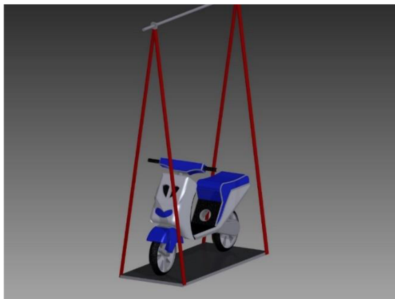
Obr. 24 Metodika měření momentu setrvačnosti k ose "x"
