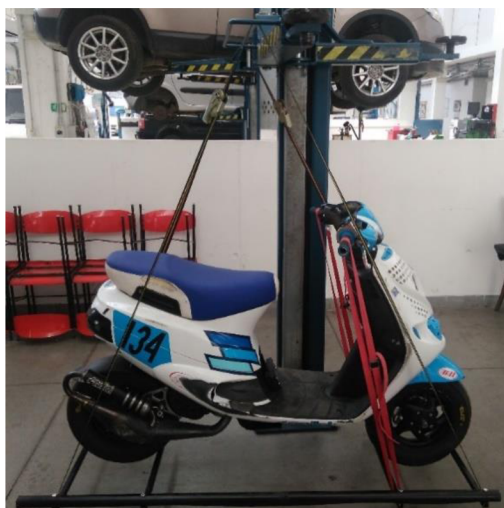
Obr. 33 Kyvadlo + vozidlo v rovnovážné poloze před změřením momentu setrvačnosti k ose x
