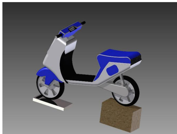
Obr. 17 Metodika měření výškové polohy těžiště motocyklu
