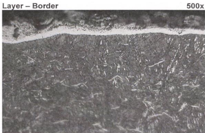
Obr. 10 - mikrostruktura hranice nitr. vrstvy a nenitr. vrstvy
