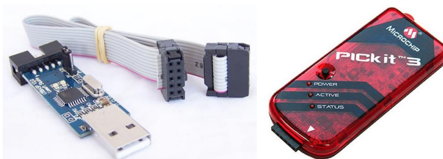
Obrázok č. 15: Na pravej strane AVR-ISP programátor, na ľavej strane PICKit 3 programátor pre PIC. [30] [71]
