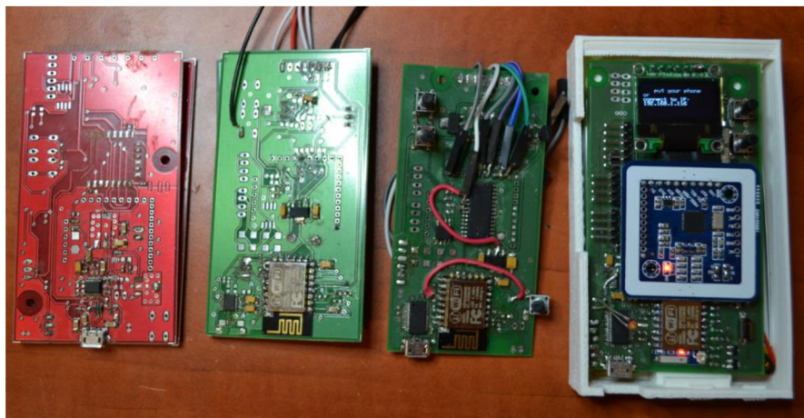
Obrázok č. 37: Jednotlivé verzie zariadenia, na pravej strane prvá, na ľavej strane posledná
