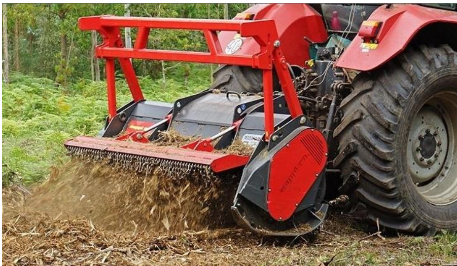
Obr. 2 Univerzální lesní fréza MIDIFORST DT [30]
