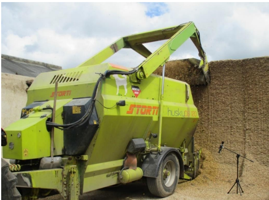
Obrázek 23 MKV Husky DS 120 a umístění hlukoměru
