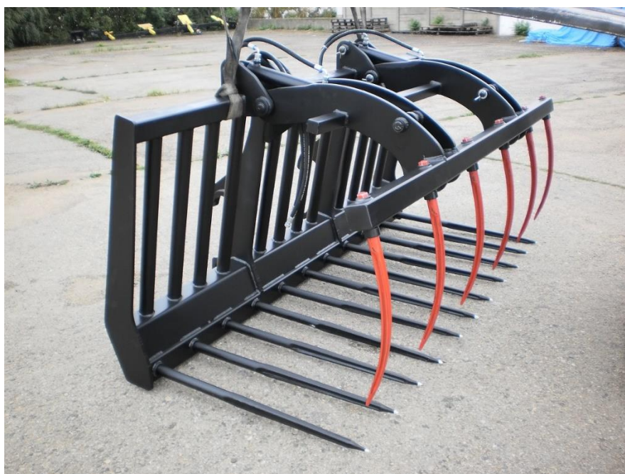
Obrázek 6 Adaptér na čelní nakladač – drapákový nakladač
