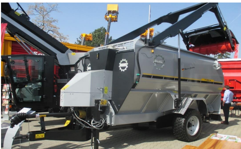
Obrázek 3 Návěsný míchací krmný vůz s horizontálně uloženými míchacími šneky
