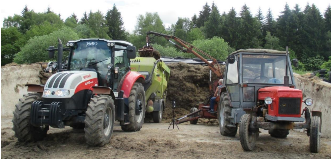
Obrázek 25 Nakládání krmiva drapákovým nakladačem UNHZ 500 a umístění hlukoměru
