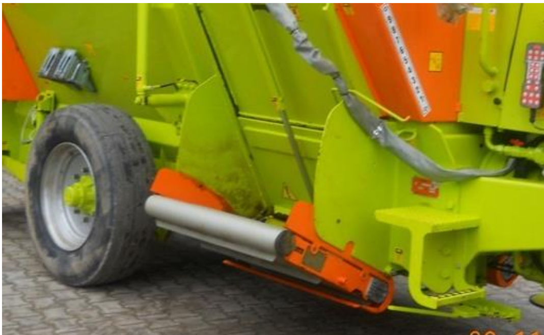
Obrázek 11 Pásový vykládací dopravník
