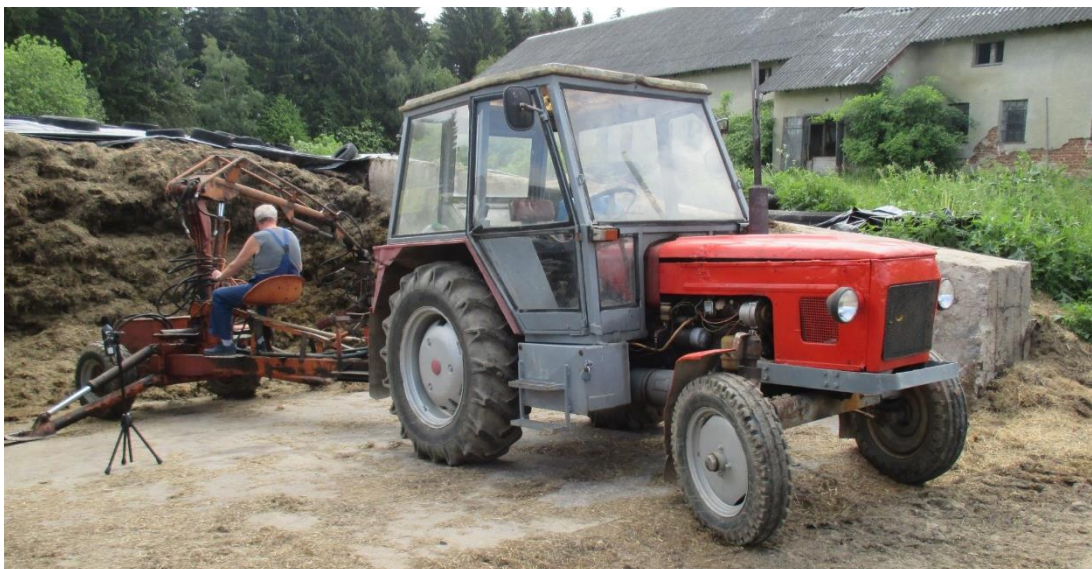
Obrázek 22 Drapákový nakladač UNHZ 500 v agregaci se Zetorem 5011
