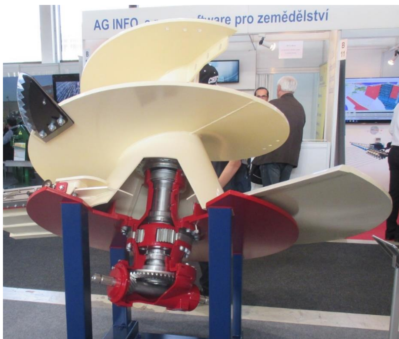
Obrázek 10 Míchací vertikální šnek
