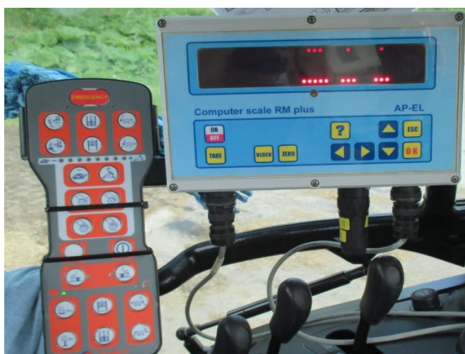
Obrázek 7 Ovládací terminál vážicího systému Zdroj: autor
