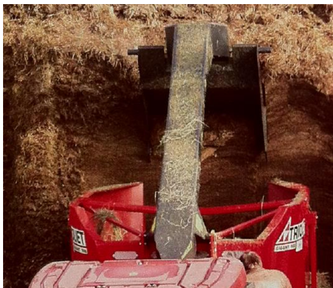
Obrázek 5 Nakládací zařízení s vybíracím štítem
