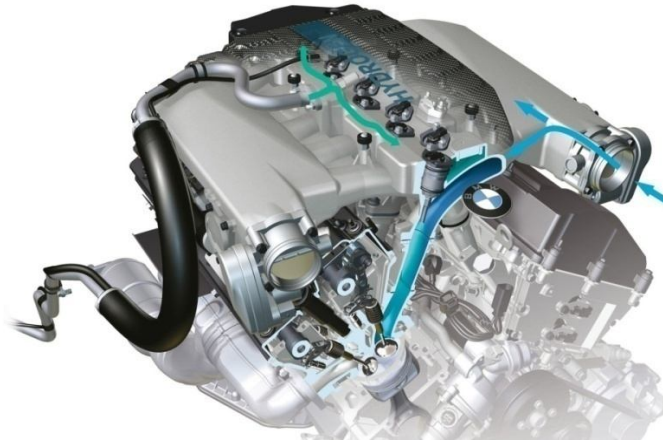
Obr. 21 BMW Hydrogen 7 motor – tvorba směsi vodík/vzduch [34]
