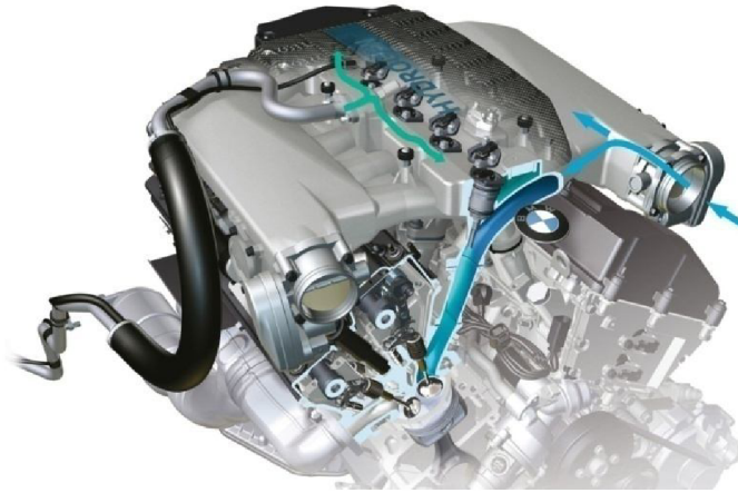
Obr. 21 BMW Hydrogen 7 motor – tvorba směsi vodík/vzduch [34]
