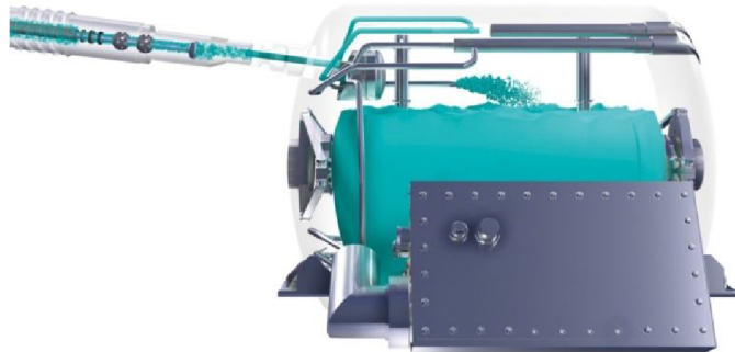
Obr. 22 BMW Hydrogen 7 – schéma plnění nádrže [34]
