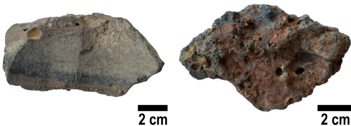
Obr. 8 Krystalická struska z lokality PL vlevo, barevná sklovitá struska z lokality ČP vpravo.
