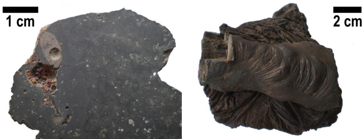
Obr. 9 Výrazná sulfidická inkluze vlevo, struska připomínající svým povrchem provazcovou lávu vpravo, oba vzorky z lokality PL.
