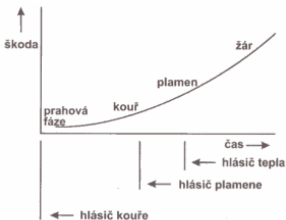
Obrázek 9: Detekce vznikajícího požáru v jednotlivých vývojových fázích
