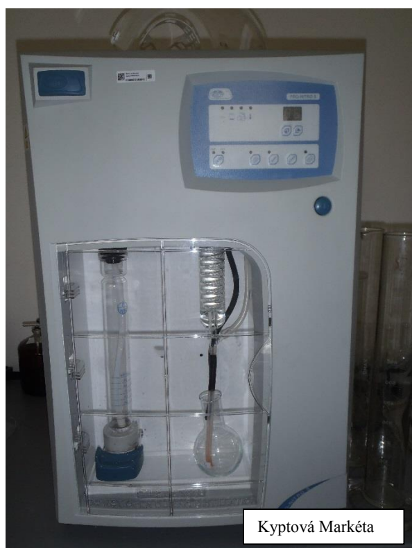
Obrázek 2: Pro- Nitro II- destilační zařízení Obrázek 3: Block digest- mineralizační zařízení
