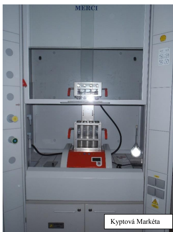
Obrázek 2: Pro- Nitro II- destilační zařízení Obrázek 3: Block digest- mineralizační zařízení
