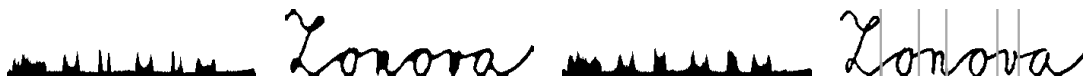
Obrázek 3.4: Ukázka vertikální projekce pro původní obraz slova, obraz po provedení morfologických operací, jeho vertikální projekce a výsledná segmentace znaků
