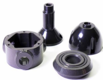
Obr.19 Acetonem vyhlazené ASA výtisky (přechodky, krytky) [30]
