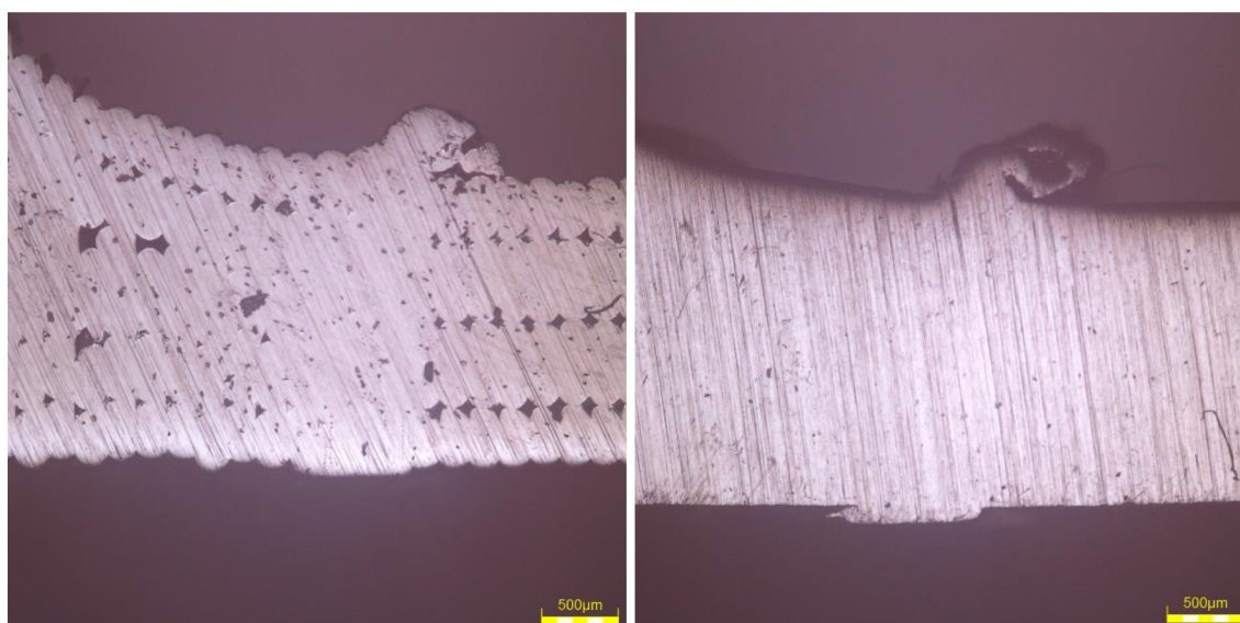
Obr.62 Porovnání svaru vzorků z materiálu ASA Vlevo vyrobený AT Vpravo vyrobený vstřikováním
