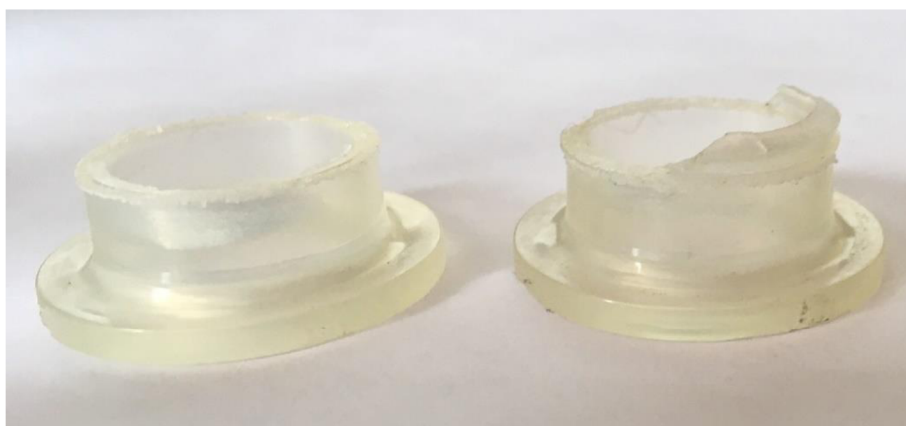
Obr.67 Lom vstříkovaného materiálu PLA Vlevo porušení v celém průřezu svarové plochy Vpravo částečné porušení v oblasti mimo svarovou plochu
