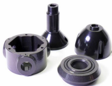
Obr.19 Acetonem vyhlazené ASA výtisky (přechodky, krytky) [30]
