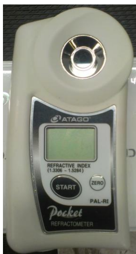
Obr. 22: Digitální refraktometr ATAGO PAL-RI
