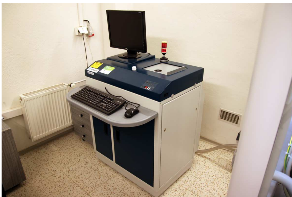
Obrázek č.18: Energiově dispersní fluorescenční spektrometr EX6600 Xenometrix
