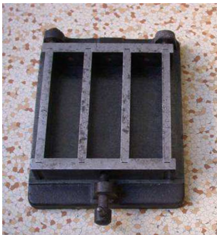
Obrázek č.14: Forma pro přípravu zkušebních trámčků 40x40x160 mm
