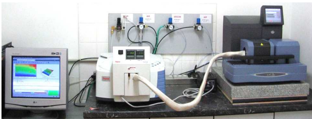
Obrázek č.16: Přístroj TA INSTRUMENTS Q600 + THERMO NICOLET IS10 pro TG – DTA – EGA + FTIR analýzu
