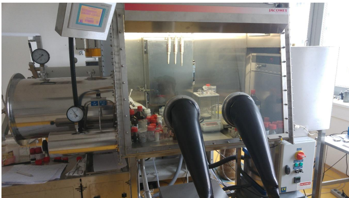
Obr. 24. Box s argonovou atmosférou
