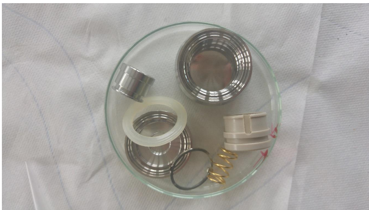
Obr. 23. Části elektrochemické cely
