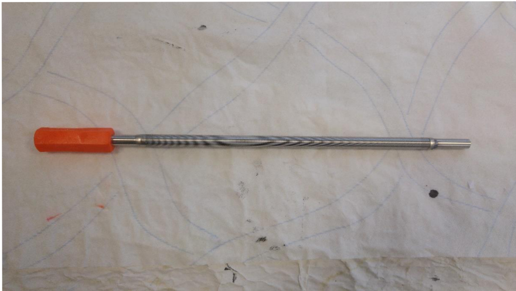
Obr. 20. Tyč pro nanášení hmoty o výšce 60 \mu\text{m}
