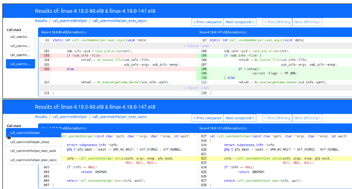
Obrázek 5.4: Snímky výsledného řešení zobrazení nalezeného rozdílu. Na horním snímku je zachyceno zobrazení zdrojového kódu funkce při výběru funkce s nalezeným sémantickým rozdílem ze zásobníku volání. Na dolním snímku je zachyceno zobrazení při výběru volající funkce (v tomto případě porovnávané funkce). Vytvořené řešení má na obrazovkách s nižším rozlišením zmenšený zásobník volání, který se zvětší při najetí kurzoru myši. Nezobrazené části kódu je možné zobrazit kliknutím na „Expand lines“. Jedná se o zobrazení stejného rozdílu, který byl zobrazen na Výpisu 2.1.
