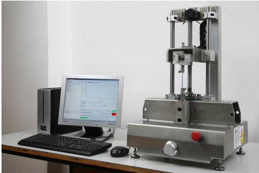
Obr. 1: Zařízení pro statickou zkoušku tahem [3]
