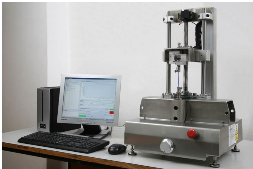
Obr. 1: Zařízení pro statickou zkoušku tahem [3]
