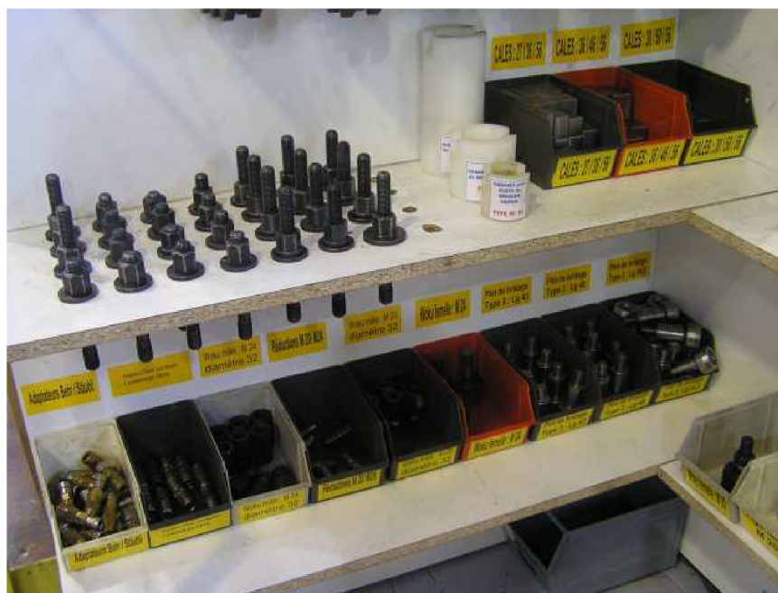
Obr. 2-4 Ukázka pracoviště, na kterém je prováděna metoda 5S[15]
