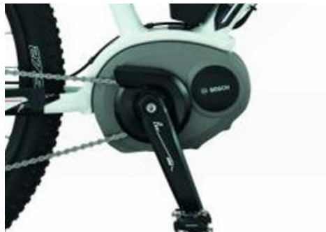
Obrázek 40 Elektromotor ve středovém složení má kladný vliv na vyvážení kola [27]
