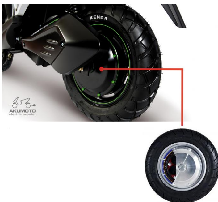
Obrázek 36 Elektronický skútr od české firmy Akumoto s motorem umístěným v náboji kola [58]
