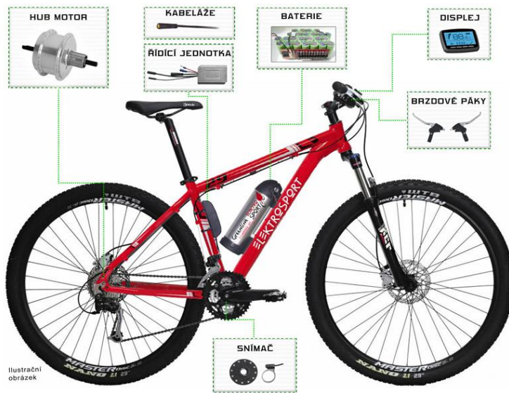
Obrázek 37 Z čeho se skládá elektrokolo [59]
