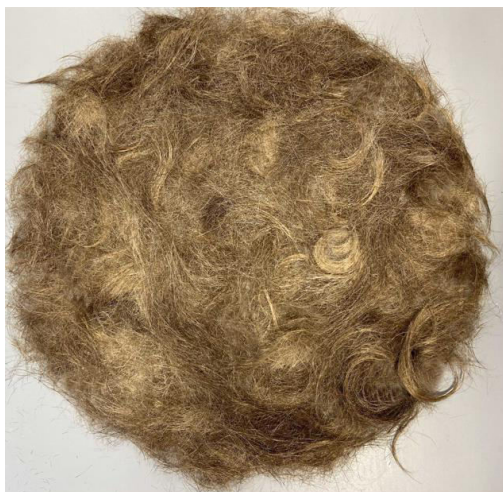
Obrázek 39 Netkaný biosorbent z vlasů
