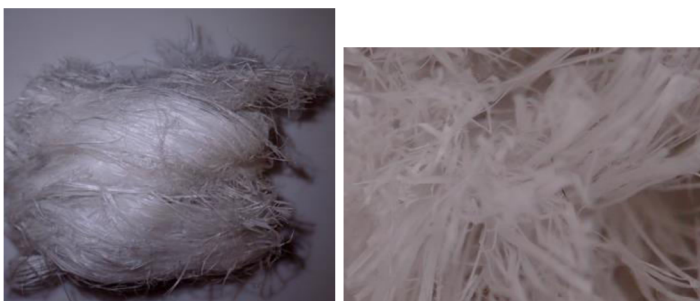
Obrázek 13 Vzorek hydrofobní stříže REO a její detail
