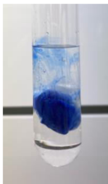
Obrázek 22 Vložení vzorku do zkumavky s obarveným olejem a vodou
