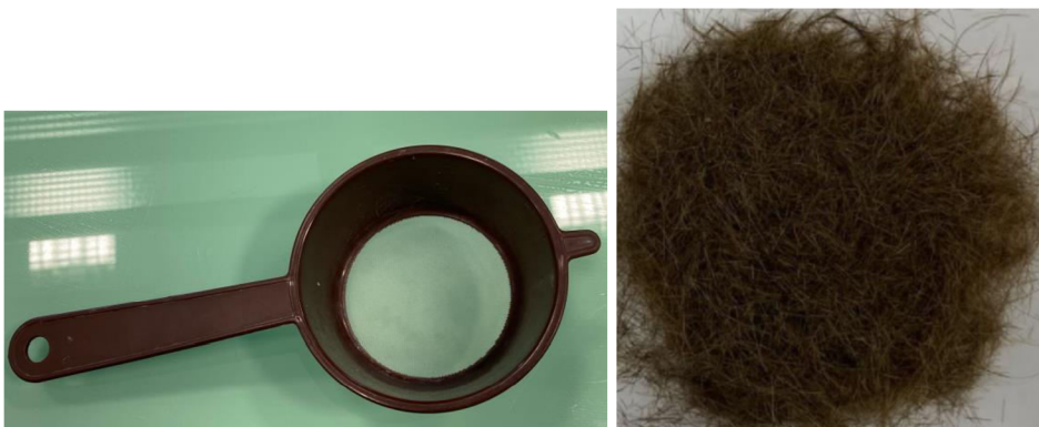
Obrázek 16 Použité síto a vytvořená netkaná vrstva z vlasů
