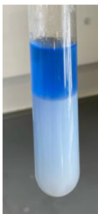
Obrázek 23 Proces oddělování vody od petroleje po vyjmutí vzorku
