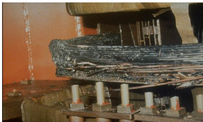
Obrázek 6 Zničený transformátor v elektrárně Salem (New Jersey) při geomagnetické bouři v roce 1989
