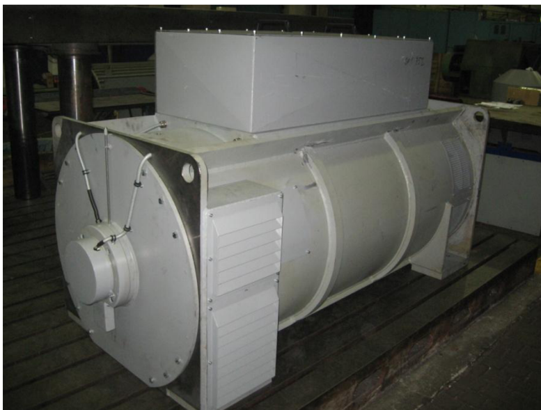
Obr. 3-6 Vyroběný generátor připravený k přesunu na zkušebnu
