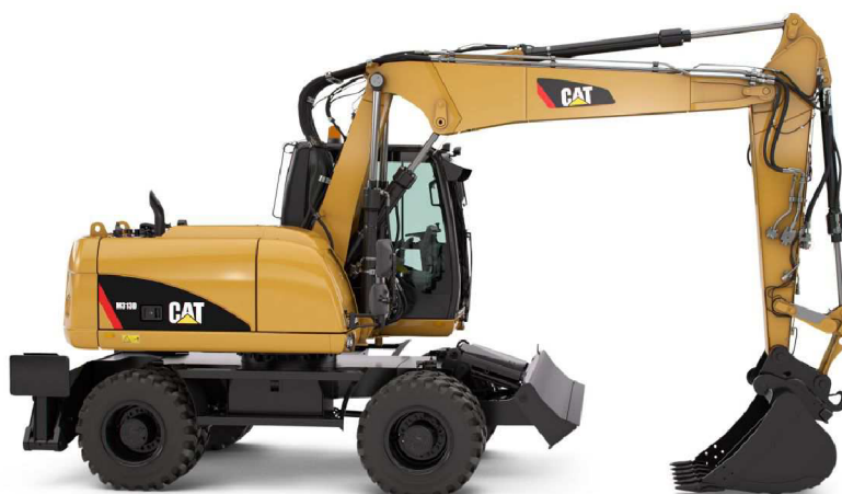
Obr. 5.7 Kolové rypadlo CAT M313D
