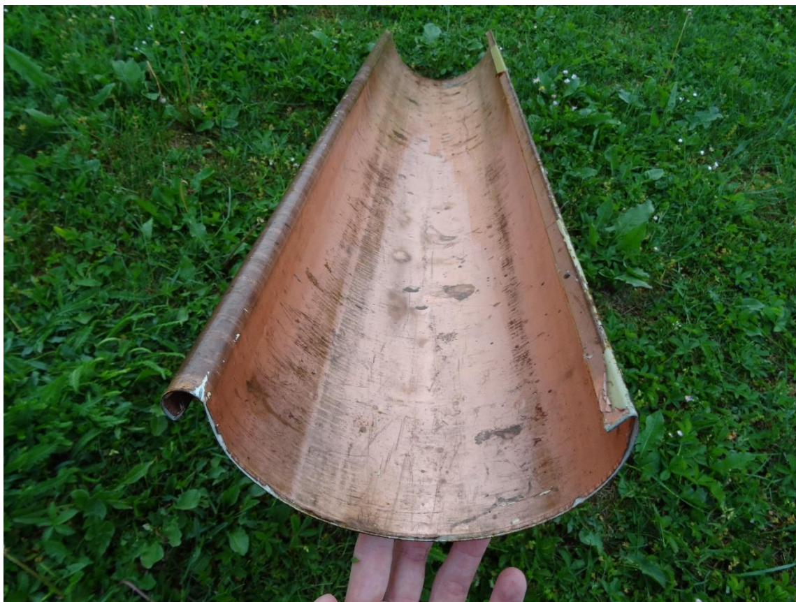
Obrázek 24. Odtokový žlab, vystaven 30 měsíců povětrnostním vlivům.
