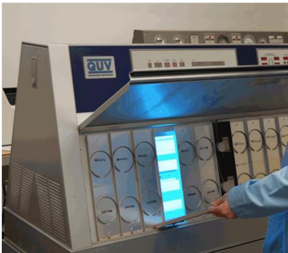
Obrázek 4. QUV tester, komora urychlující stárnutí materiálu. [23]
