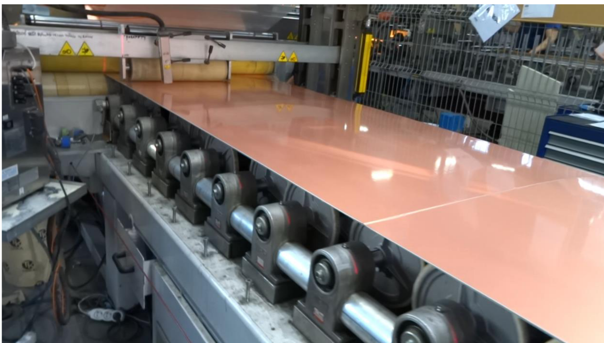
Obrázek 23. První zkušební jednostranně laminované plechy (1000x 2000 mm).
