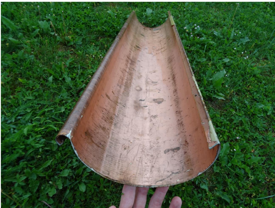
Obrázek 24. Odtokový žlab, vystaven 30 měsíců povětrnostním vlivům.
