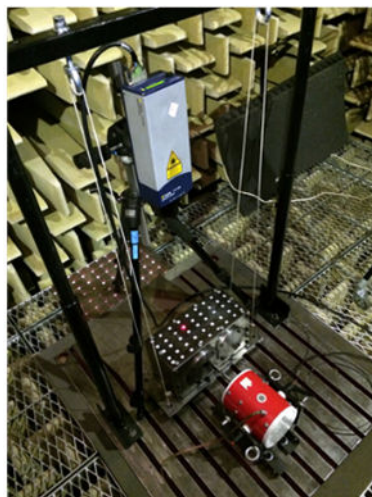
Obr. 3.7 Bezkontaktní měření normálové rychlosti povrchu
