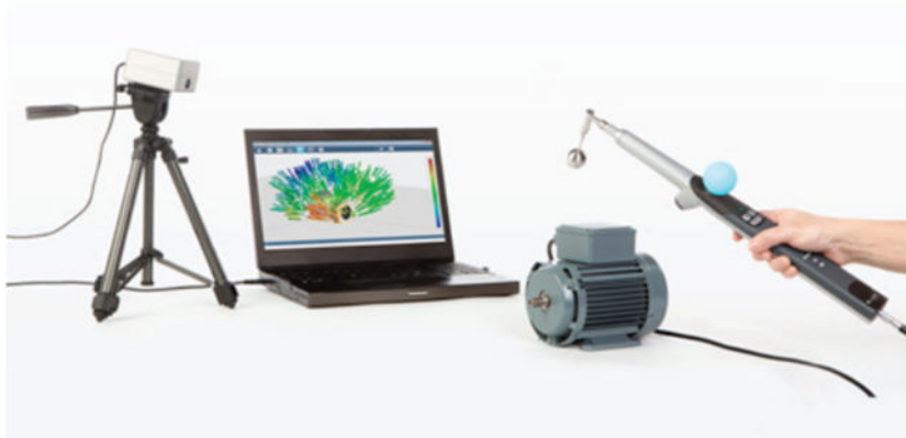
Obr. 3.16 Zařízení pro lokalizaci zdrojů hluku SoundBrush
