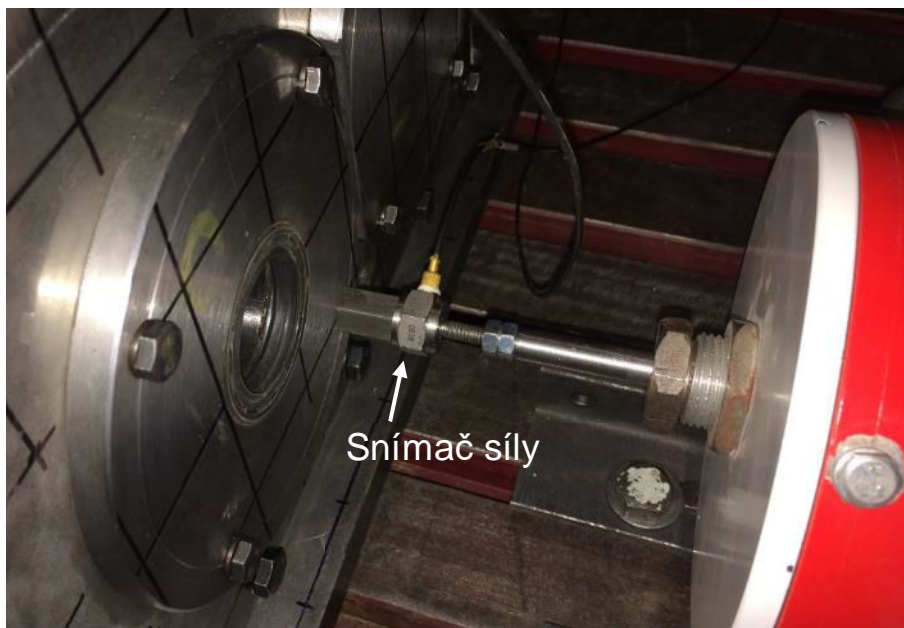
Obr. 5.11 Ukázka připojení modálního budiče na skříň přes šroubový spoj jednoho z více ložisek, zároveň je zobrazeno umístění siloměru v měřícím řetězci
