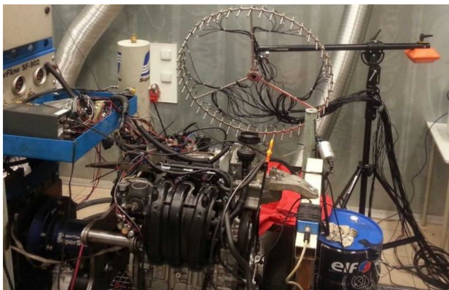
Obr. 3.15 Lokalizace zdrojů hluku pomocí akustické kamery
