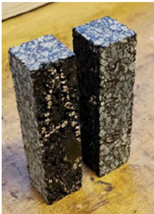
Obr. 31 Připravená zkušební tělesa [1]
