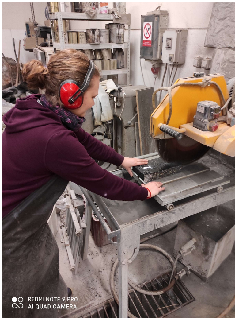
Obr. 21 Řezání diamantovou pilou
