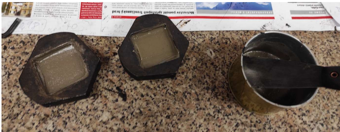
Obr. 23 Rozprostření lepidla do čelistí pro zkoušku posouzení nízkoteplotních vlastností
