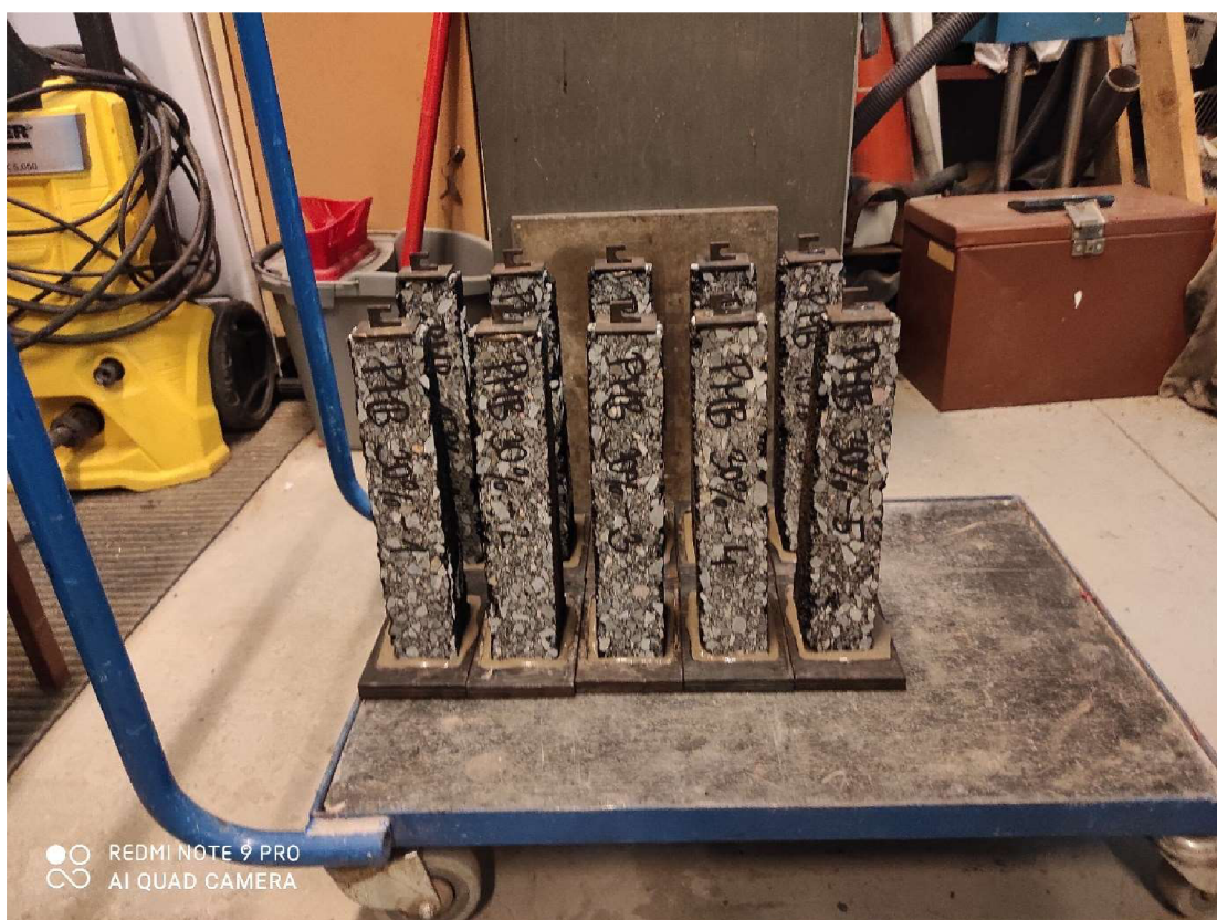
Obr. 24 Zkušební tělesa: komolé klíny (trapezoidy) přilepené k podložkám
