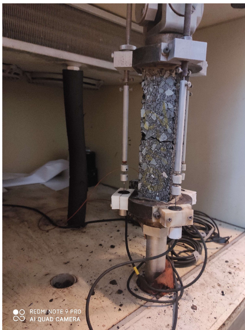
Obr. 32 Porušený zkušební vzorek v měřícím zařízení
