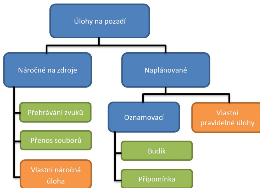
Obrázek 2.5: Rozdělení úloh běžících na pozadí. Oranžově jsou vyznačeny programátorem vytvořené úlohy. Zeleně jsou označeny předchystané a specializované úlohy a modře obecné typy úloh. Upraveno podle [3].
