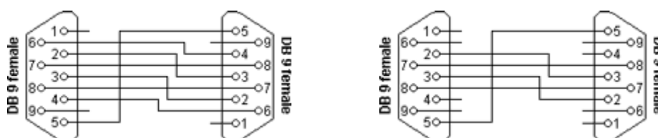
Obr. 3. 2: Propojovací kabely v 7 drátovém propojením s úplným řízením toku a 3 drátovým propojením-null modem [7].
