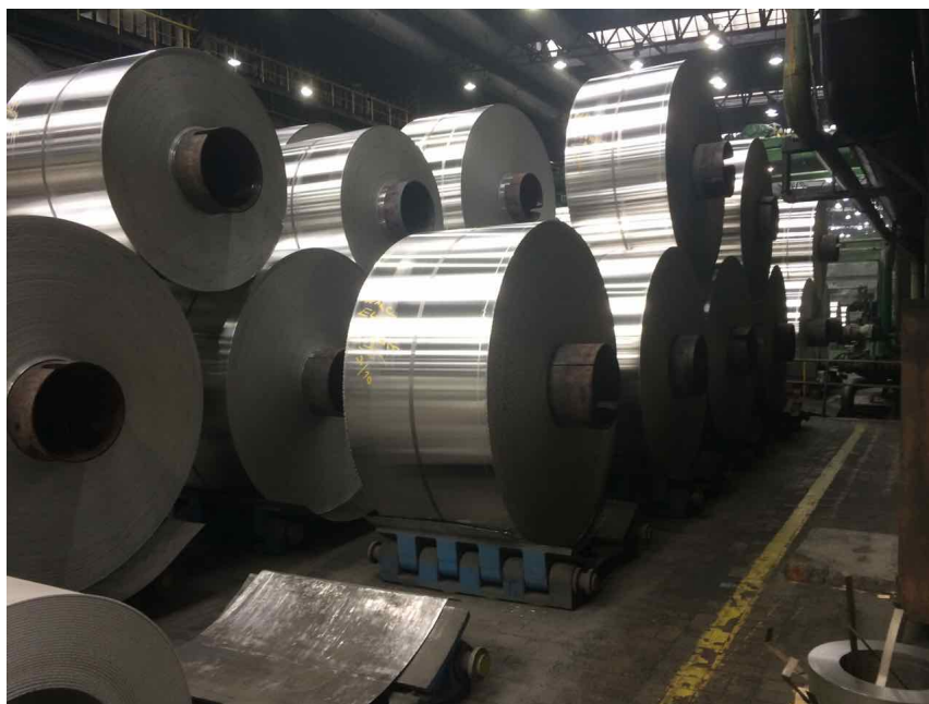
Obr. č. 33: Vyrobený hliník, navinutý ve válcích (Zdroj: vlastní)
