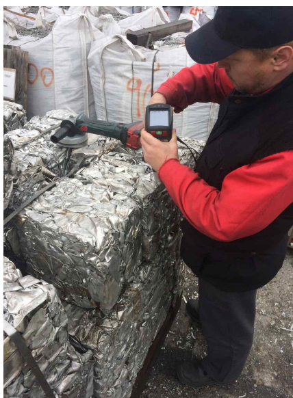
Obr. č. 30: Kontrola kvality hliníkové šrotu pomocí spektrometru (Zdroj: vlastní)
