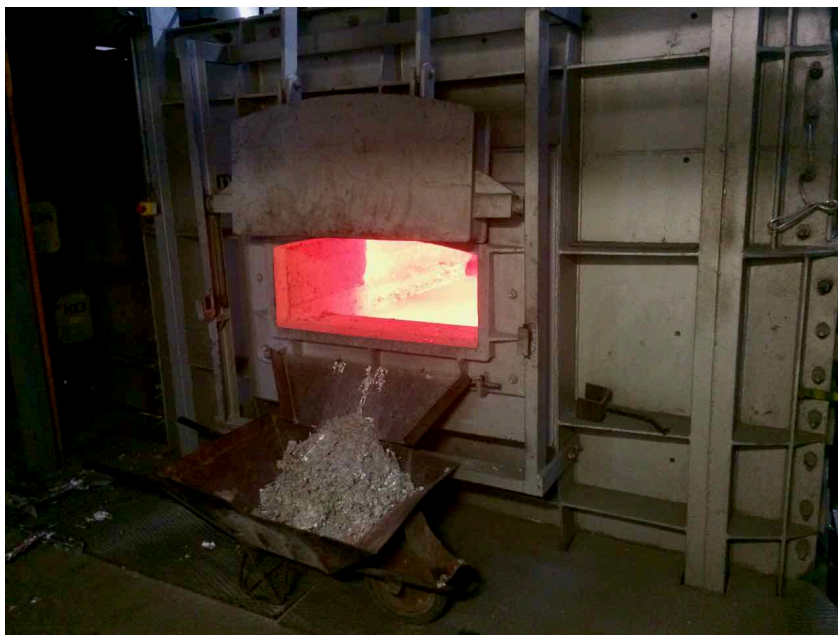
Obr. č. 32: Sběr stěru z elektrické pece (Zdroj: vlastní)
