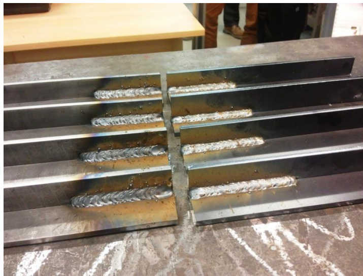
Obr. 47: Porovnání svařenců obou typů ocelí při vizuálním hodnocení
