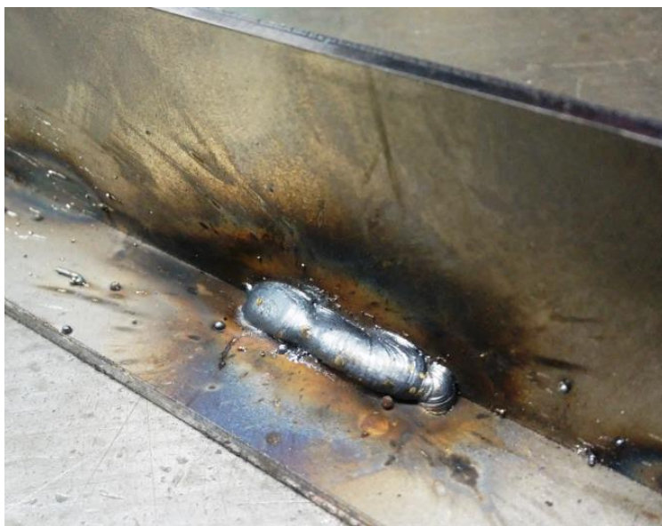
Obr. 16: Studený spoj a rozstřík (Autor)
