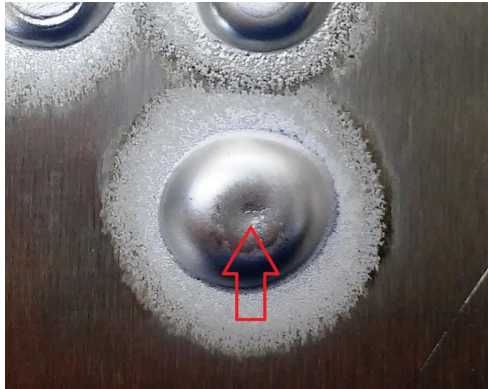
Obr. 15: Mikrotrhlina ve svaru (Autor)
