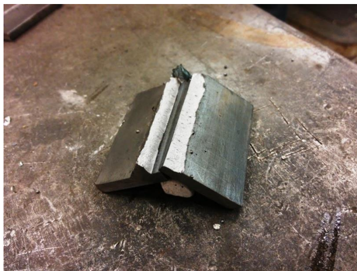
Obr. 51: Zvlnění lomové plochy při nerovnoměrném působení tlakového zatížení
