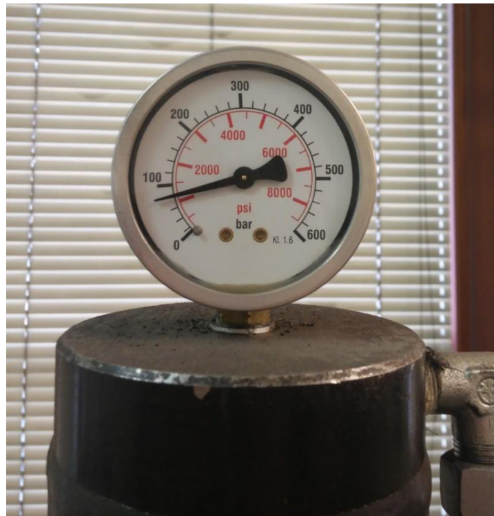
Obr. 49: Ukázka typické hodnoty zatěžovacího tlaku u oceli 90MnCrV8
