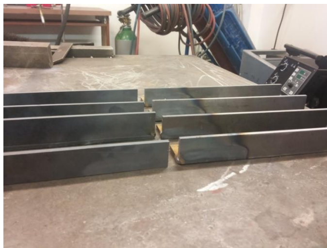
Obr. 48: Zviditelnění přechodové oblasti (TOO)
