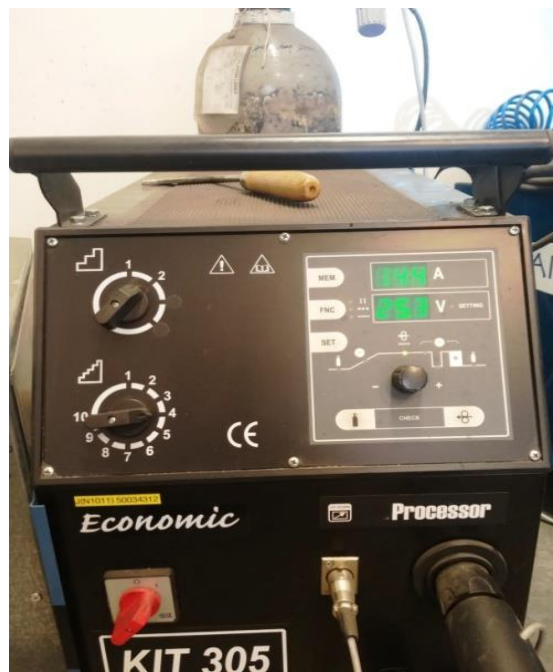
Obr. 30: Nastavené parametry pro svařování
