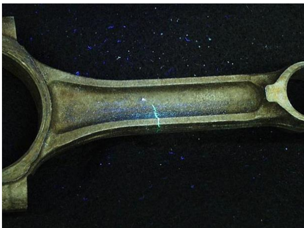
Obr. 20: Znázornění vady při kapilární zkoušce (Technologie 1 ČVUT, 2011)
