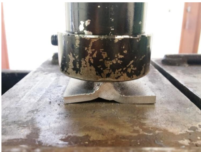
Obr. 54: Plastická deformace svařence z materiálu S235JRC
