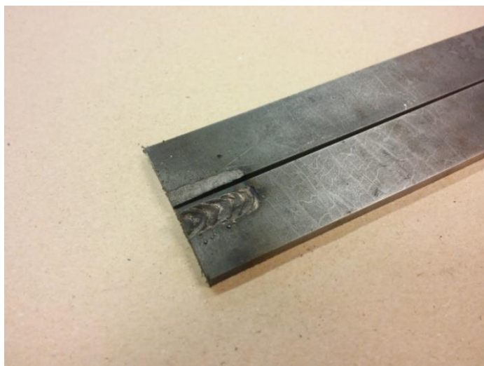
Obr. 52: Porušení svaru při přípravě vzorku
