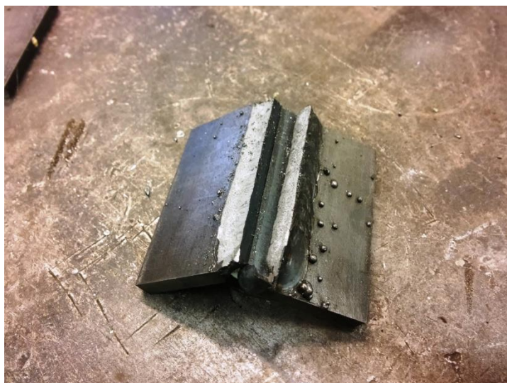
Obr. 50: Masivní rozstřík svarového kovu a poloha štěpné trhliny
