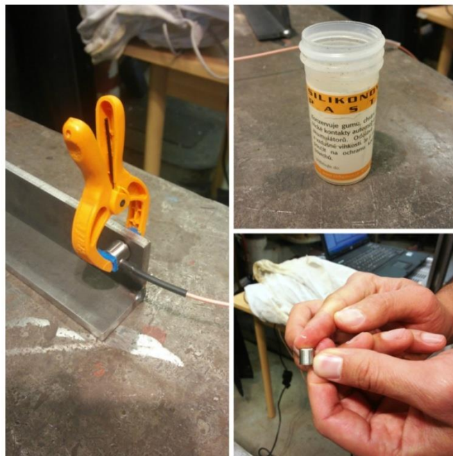
Obr. 28: Příprava a umístění snímače na vzorek
