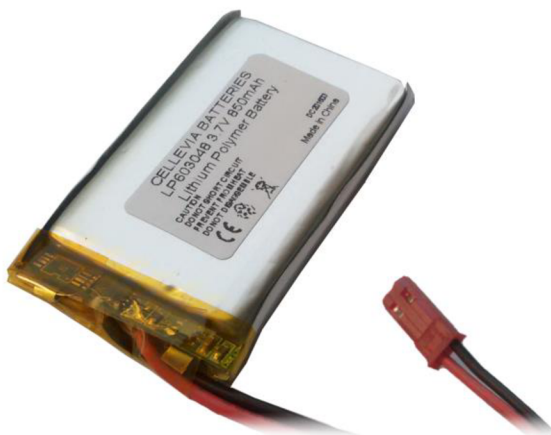
Obrázek 2-4: Akumulátor Li-Pol 850 mAh
