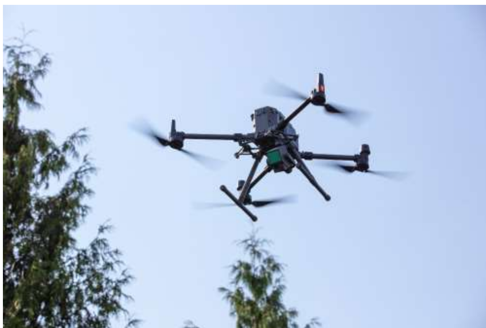
obr. č. 18 – dron DJI Matrice 300 RTK se skenerem DJI Zenmuse L1 – zdroj: Drony SIT
