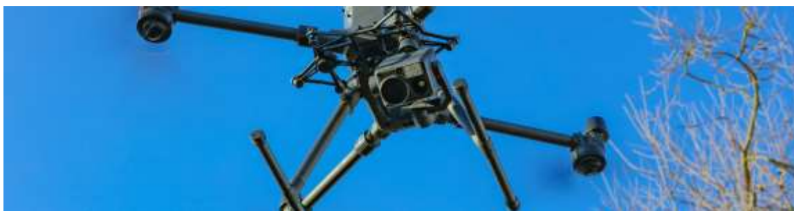
obr. č. 22 – dron DJI Matrice 300 RTK se senzorem DJI Zenmuse H20T – zdroj: Drony SIT
