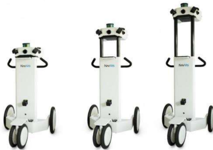
obr. č. 26 – mapovací vozík NavVis M6 - zdroj: NavVis GmbH
