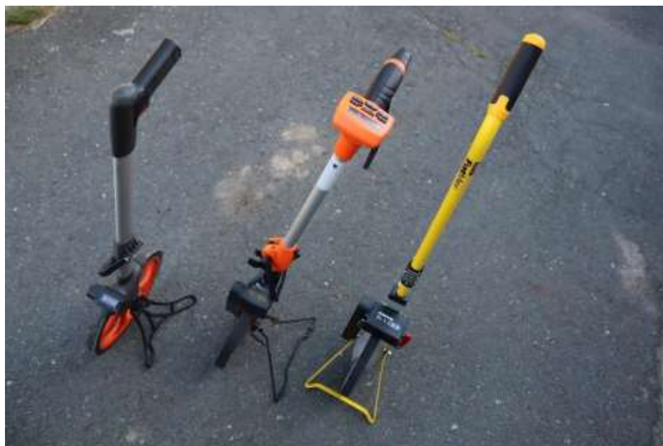
obr. č. 3 – měřičská kolečka - zdroj: foto vlastní
