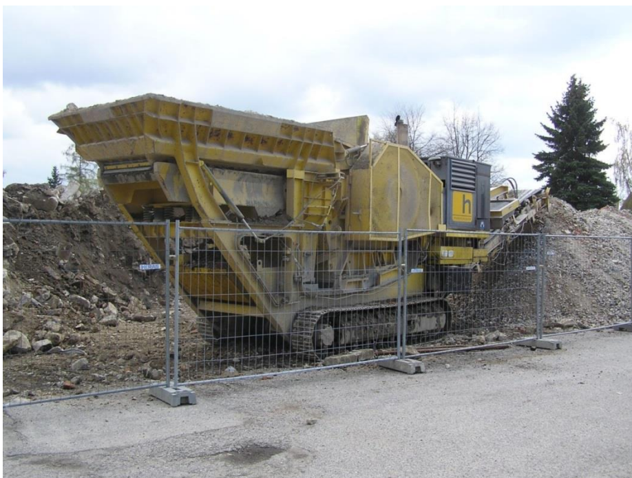
Obrázek 15 - Drcení demoličního odpadu [zdroj: autor]
