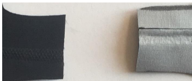
Spoj č. 5 zahnutý přeplátovaný spoj (pouze ultrazvukem svařený) nepodlepený, materiál M2
