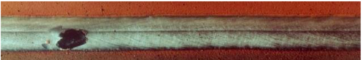
Obr. 8. Svařování nelegované oceli, drát G3Si1, plyn 82% Ar + 18% CO 2
