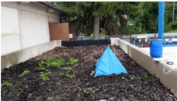
Obrázek 21 - Vzorkování na plošném zdroji [47]
