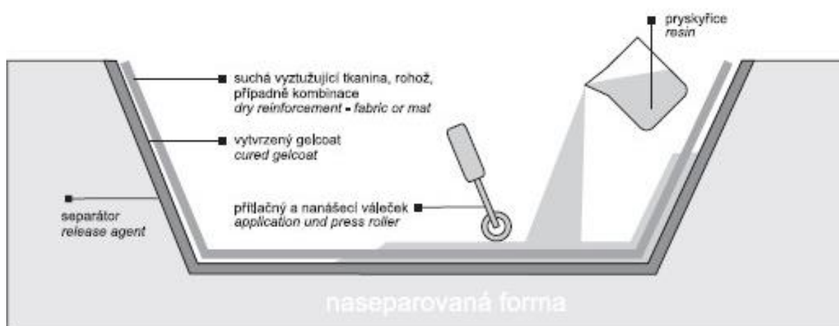
Obrázek 19 - Ruční kladení [46]
