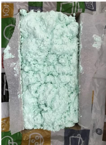
Obrázek 51 - Vzorek po vytvrnutí
