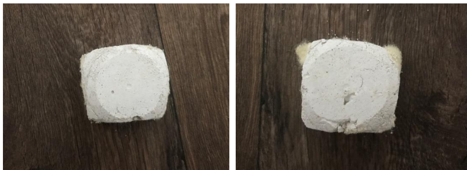
Obrázek 68 - Vzorek z v. – úpr. pit. v. Obrázek 69 - Vzorek z vápna - úprava jedlou sodou
