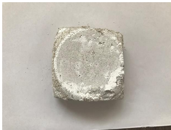
Obrázek 71 - Vzorek z vápna bez použití ovčí vlny
