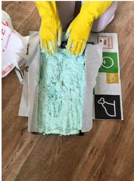
Obrázek 49 - Třetí vrstva z PU pěny
