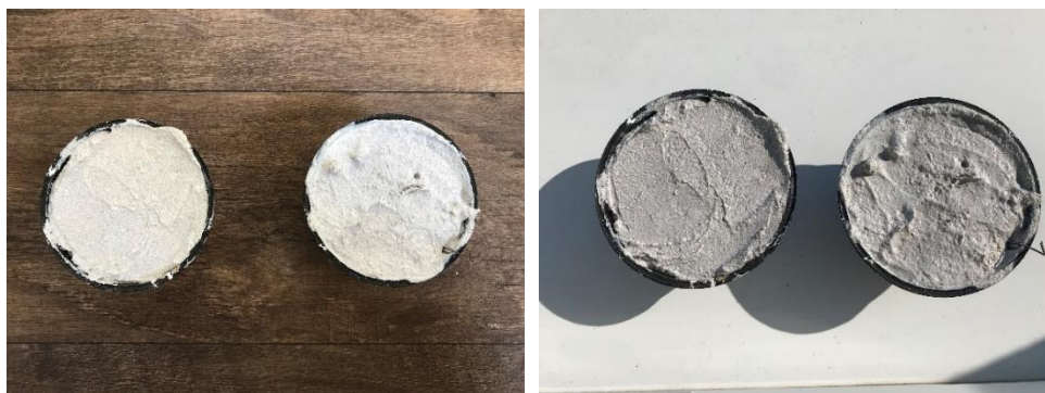
Obrázek 66 - Vzorky z vápna a upra. vl. Obrázek 67 - Vzorky vystavené slunečnímu záření
