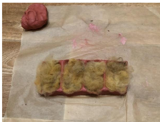
Obrázek 25 - Vyplnění formy surovou vlnou
