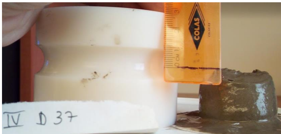
Obrázek 56: Reometrické vlastnosti - sednutí kužílku - D37
