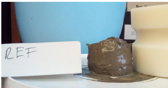
Obrázek 52: Reometrické vlastnosti - sednutí kužílku - cem_ref
