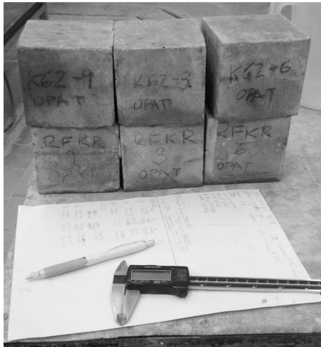
Obrázek 34: Příprava před zkouškou pevnosti v tlaku
