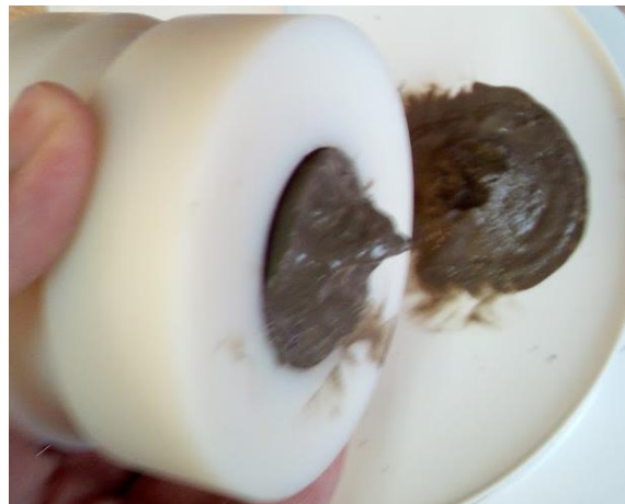
Obrázek 61: Utržení při zkoušce sednutí kužílku v čase 25"
