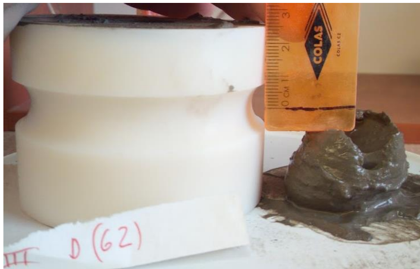
Obrázek 58: Reometrické vlastnosti - sednutí kužílku
