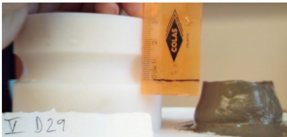
Obrázek 54: Reometrické vlastnosti - sednutí kužílku - D29
