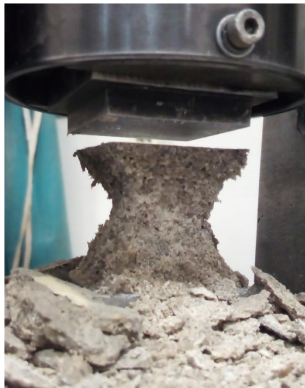
Obrázek 33: Očekávané porušení ve tvaru přesýpacích hodin.
