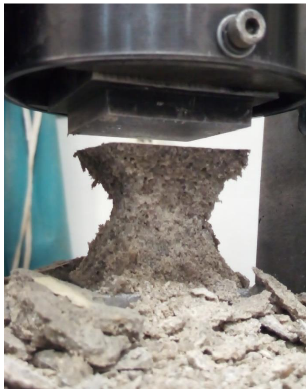
Obrázek 33: Očekávané porušení ve tvaru přesýpacích hodin.
