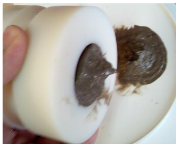
Obrázek 61: Utržení při zkoušce sednutí kužílku v čase 25"
