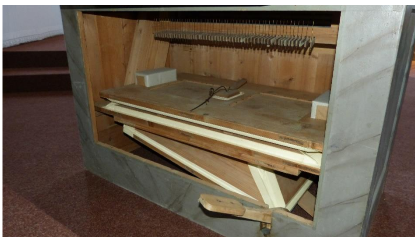
Obrázek č. 18: Klínový měch se zásobníkem ovládaný pákou
