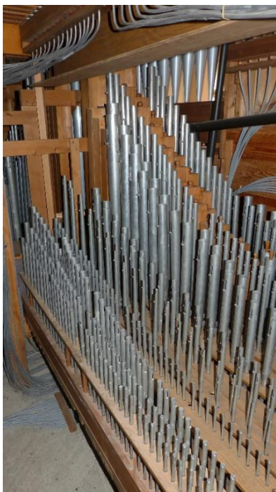
Obrázek č. 28: Vzdušnice hlavního stroje
