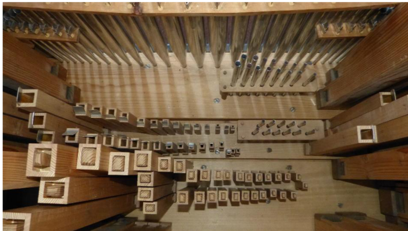
Obrázek č. 17: Pohled na vzdušnici s pišťalami
