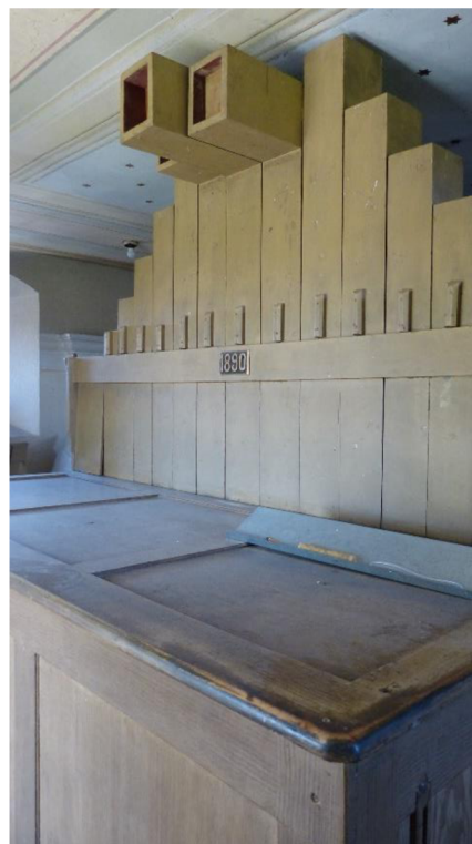
Obrázek č. 22: Pohled na kryt měchu
