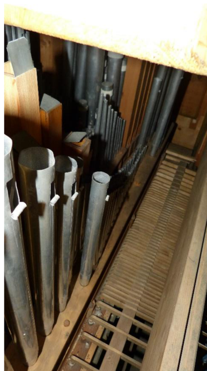
Obrázek č. 20: Manuálová traktura
