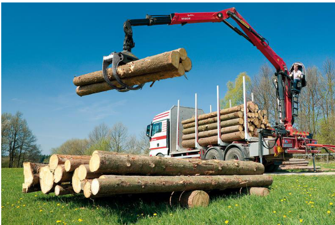
Obr. 15: Nakládání dříví hydraulickou rukou (foto Mascus, 2016)
