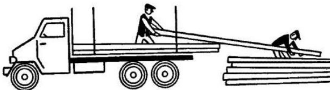
Obr. 12: Ruční nakládání dlouhého dříví provlékáním mezi klanicemi (foto Neruda, Simanov, 2006)
