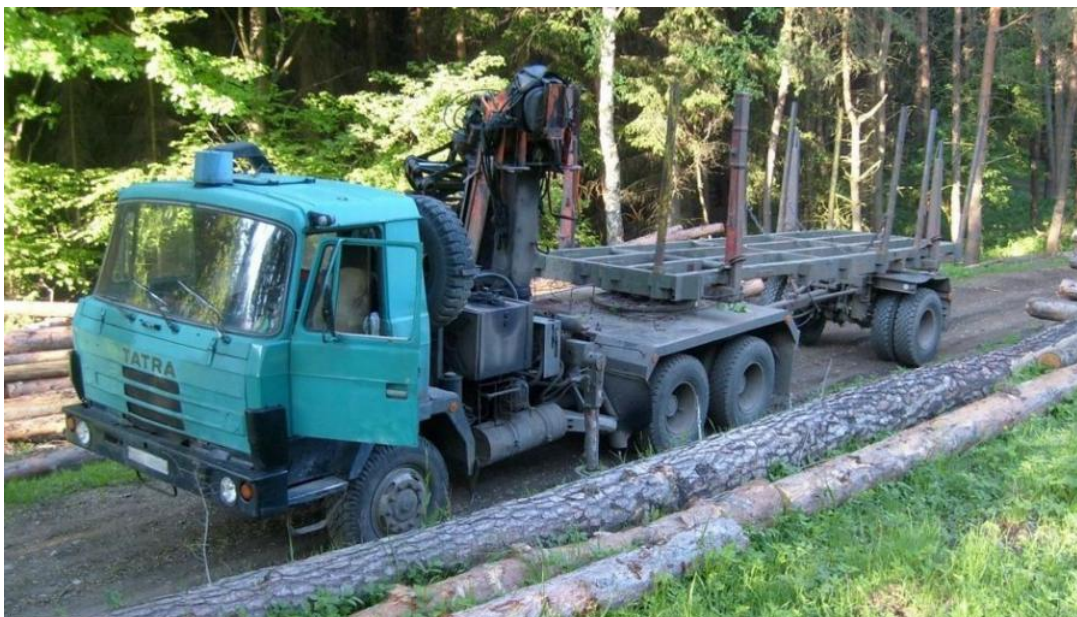
Obr. 3: Tatra 815 P17 s HR HIAB 900 + DAV7 (foto nakladni.autobazac.cz, 2016)
