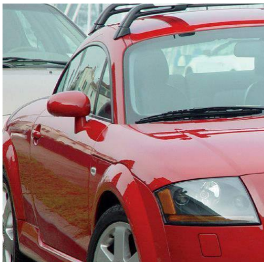
Obr. 5 Fresnelův efekt, boční okénka odrážejí více světla než přední okno vozidla
